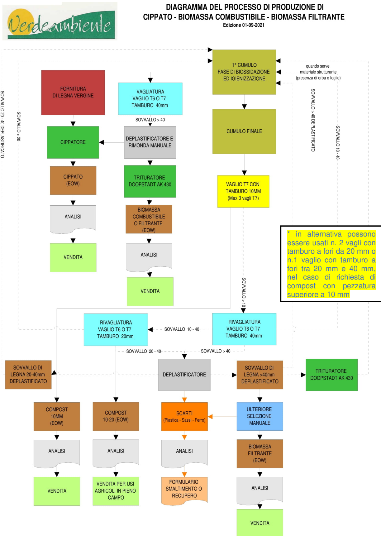
Figura B8 - Schema di processo produzione di cippato – biomassa combustibile – biomassa filtrante
